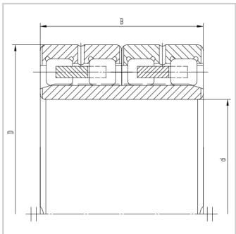
四列圆柱滚子轴承通常以过盈配合安装在轧辊颈上，特别适合轧钢速度高的轧钢机应用。这些轴承的低横截面允许使用同轧辊直径相比相对较大的轧辊颈直径。由于可装入非常多滚子，其径向载荷能力非常高。四列圆柱滚子轴承只能承受径向载荷。因此，这些轴承同深沟球轴承或角接触球轴承或径向结构或止推结构的圆锥滚子轴承一起安装，由后者承受轴向载荷。四列圆柱滚子轴承为分离式结构，即带整体式挡边的轴承圈及滚子和保持架组件可同分离式轴承圈分开安装，或所有轴承部件均可分别安装。这在相当程度上简化了轴承安装、维护和检查。轴承内可承受一定限度的轴相对于轴承座的轴向位移。
